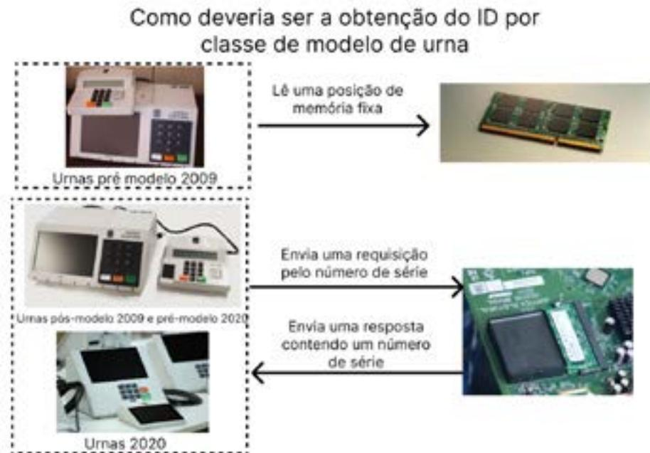
Figura B4. Diagrama ilustrando como cada uma das famílias de modelo de urna apresentadas deveria operar para obter o ID\_UE corretamente. Fonte: autoria própria
