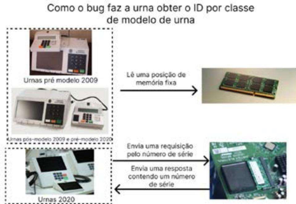
Figura B5. Diagrama ilustrando como o erro do software faz cada família de modelos de urnas funcionar. O erro no ID\_UE mostrado nos arquivos de log ocorre porque as urnas pós-UE2009/pré-UE2020 utilizam um método obsoleto para obter esse identificador, em vez de requisitar esta informação do hardware de segurança dedicado.
