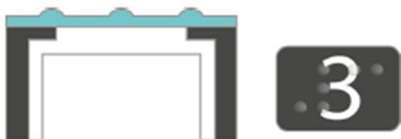
Figura 7 - Corte lateral e vista superior da tecla bi-injetada do Terminal do Eleitor
