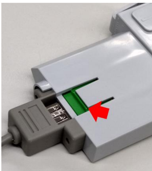
Figura 10 – Detalhe Mecanismo de “click” do drive de MR da urna modelo 2015 (esq.) e ressalto na MR (dir.)
