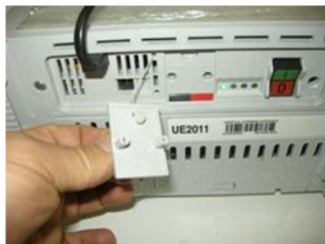
Foto 10 - Peça solta - tampa na traseira da urna presa com lacre plástico
