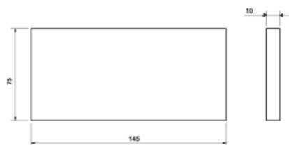
Figura 17 - Calço fixado ao lado do nicho que apoia o terminal do mesário para todas as urnas, identificado como "A" na Foto 8 do Anexo I - II
